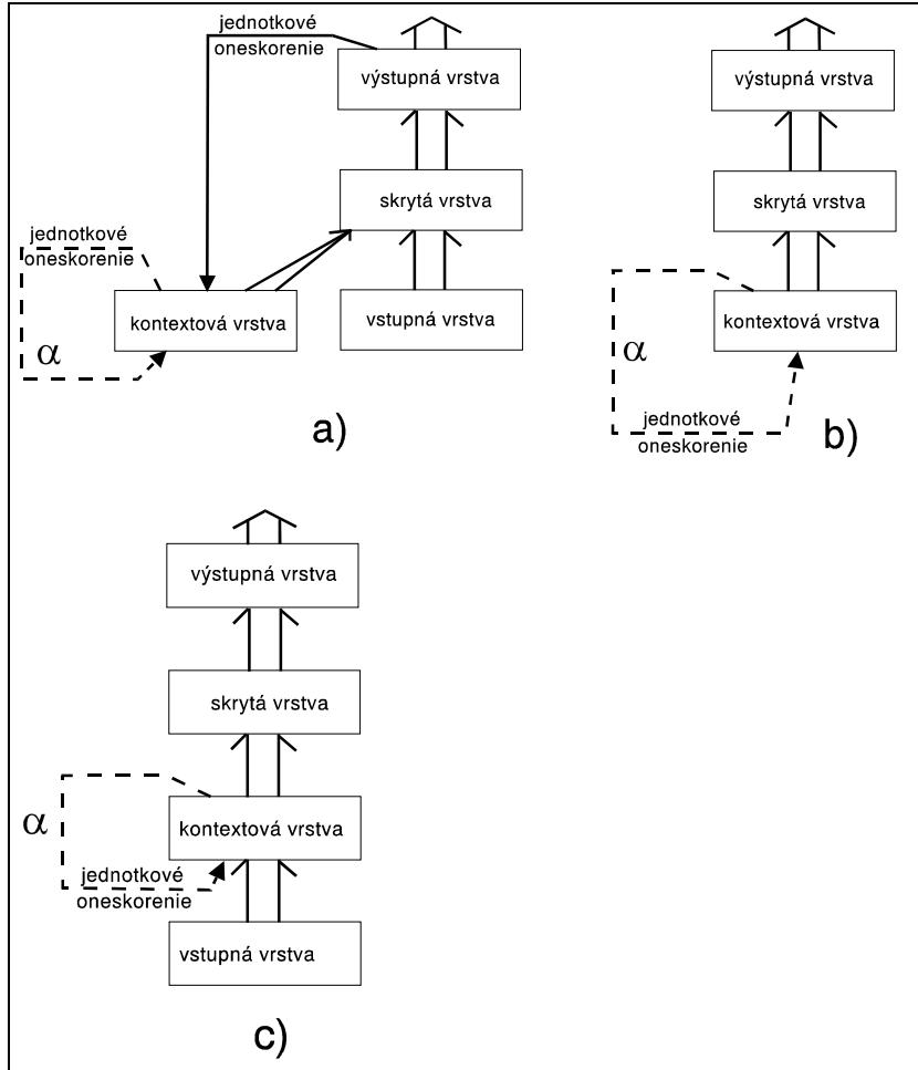
**Obrázok 7:** Architektúry rekurentných sietí s odpamätávaním aktivácií rekurentných neurónov v širšom časovom rozmedzí s prvkom zabúdania.
