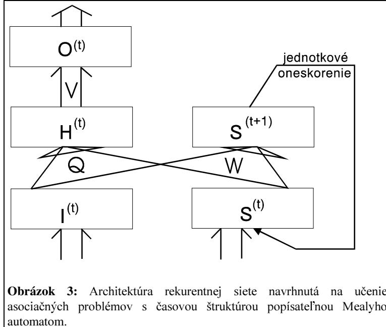
Ak sú vstupné vektory  $I^{(t)}$  z  $R^N$ , výstupné vektory z  $R^M$ , stav siete je kódovaný L rozmerným vektorom z  $R^L$  (máme L stavových neurónov) a siet' má K neurónov v skrytej vrstve, potom v architektúre siete je  $L^2 N$  váh  $W_{iln}$ ,  $KLN$  váh  $Q_{jln}$  a  $MK$  váh  $V_{mk}$ .
